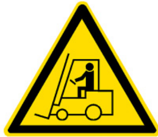
W07 Warnung vor Flurförderzeugen
