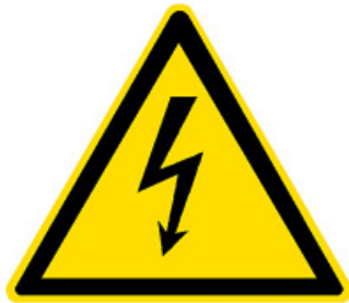
W08 Warnung vor gefährlicher elektrischer Spannung
