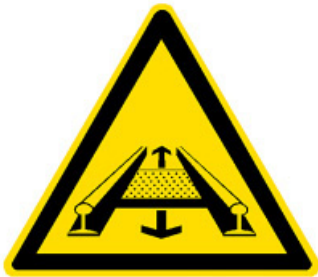
W29 Warnung vor Gefahren durch eine Förderanlage im Gleis
