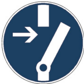
M14 Vor Arbeiten freischalten
