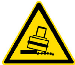
W24 Warnung vor Kippgefahr beim Walzen
